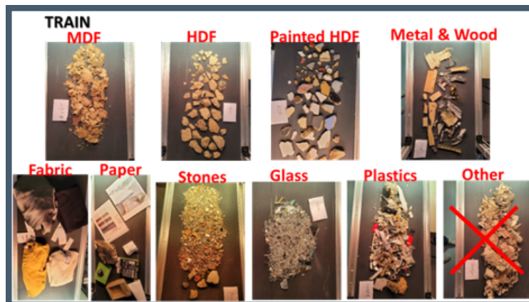
Bild: Trainingsproben verschiedener Wertstoffe zur Klassifikation von Holz und Verunreinigungen
